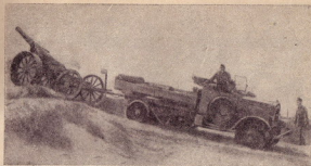
Рис. 64. Тягач «Триангель» буксирует по песчаным дюнам береговое орудие (вес 6,5 т). См. глубину погружения передних колес.
