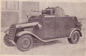
Рис. 6. Броневомобиль Ландсверн-185 на коммерческом шасси Форд, на котором дополнительно были установлены двойное управление и реверсивная передача.
