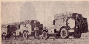
Рис. 225. Бронированный транспортер Рено 1932 г. Скошенные верхние ступени бортов дают возможность обзора, вентиляции и ведения огня для перевозимого подразделения войск.
