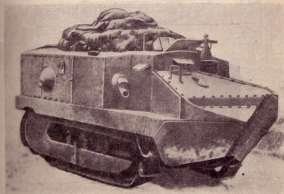
Рис. 278. Средний танк Шнейдер М. 16. Видно отсутствующее одностороннее пушечное вооружение.
