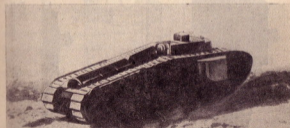
Рис. 174. Тяжелый танк марки VIII, вид вправо со стороны сабли. Второй вариант; над боевым отделением видна прямоугольная наблюдательная башенка.
