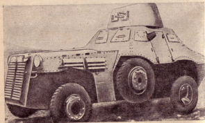
Рис. 234. Легкий броневедомитель Берлие Т. V.-U. М., вид сбоку. Ниши для колес в броневом корпусе защищают движитель без ухудшения проходимости машины.
