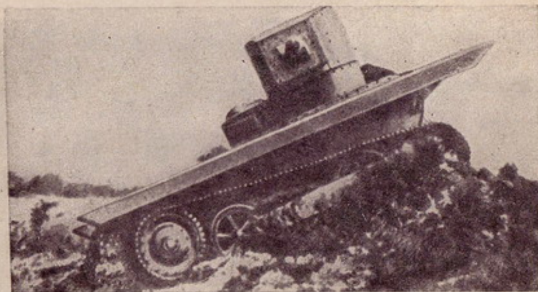
Рис. 126. Плавающий танк Виккерс — Карден-Лойд, вид сбоку. Рессорная подвеска катков прикрыта стальной пластиной. Перемещенный назад центр тяжести машины облегчает спуск в воду (сцепление гусеницы с грунтом, несмотря на всплыв носа) и выход на берег.
