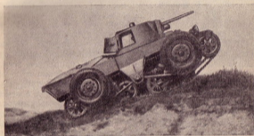
Рис. 27. Колесно-гусеничный танк Ландсверн-30 на местности с поднятыми колесами.
