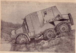
Рис. 366. 3-осный броневтомобиль на шасси Лаффли S-15-T, рекламируемый фирмой.
