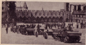
Рис. 201. Легкий артиллерийский тягач 1934 г. Обращает на себя внимание новая система подвески гусениц. Эта машина находится на вооружении английской полевой артилле- рии (4).
