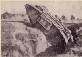
Рис. 167. Тяжелый танк марки IV вылезает из глубокого окопа с помощью балки.
