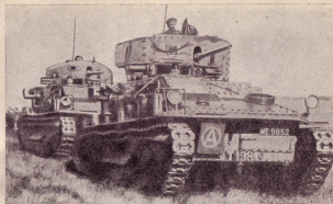
Рис. 155. Средний танк Виккерс марки IIА, вид спереди. Штыревая антенна допускает радиотелефонную связь в мехсоединении.
