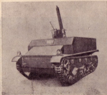
Рис. 205. То же, но пушка в положении для зенитной стрельбы. Вооружен и экипаж переводятся в машину.
