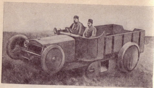
Рис. 300. Колесно-гусеничный грузовик Сен-Шамсон в 80 л. с. в момент езды с поднятыми колесами.
