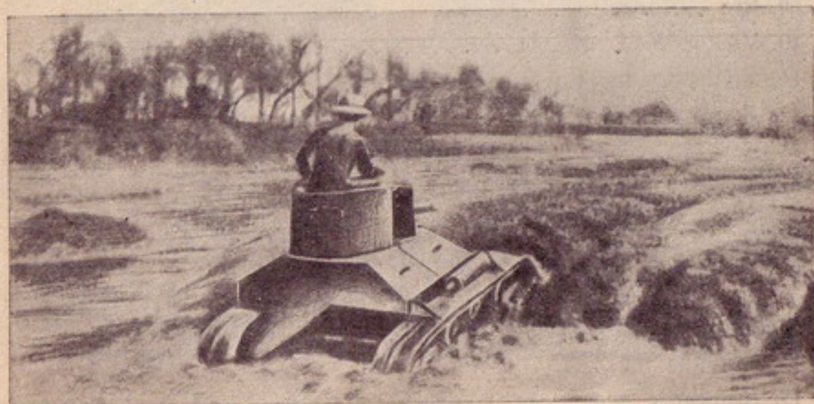
Рис. 134. Легкий танк марки IA, вид сзади. Командир танка стоя ведет наблюдение со своего места через открытую крышку башни. Фотография относится к моменту испытаний танка в Индии в январе 1931 г.
