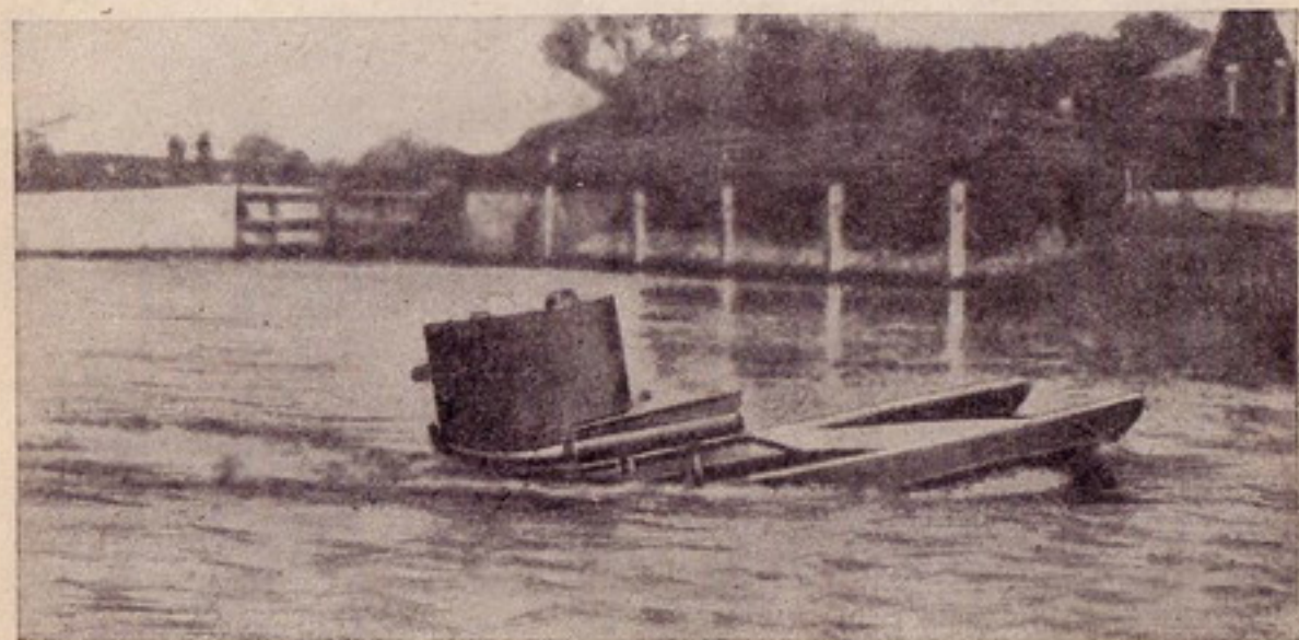
Рис. 128. Плавающий танк Виккерс—Карден-Лойд в воде, вид сбоку. Скошенная линия крыши танка по отношению к воде происходит из-за помещения центра тяжести машины позади центра водоизмещения. Этот скос увеличивается от скорости плавания и желателен.
