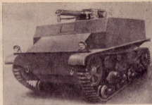
Рис. 204. Трактор Винклерс-Армстронг с 40-мм противотанковой и зенитной пушками. Данные, как у 6-тонного танка.
