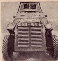
Рис. 233. Легкий броневедомитель Берлие Т. V.-U. М., вид спереди. Выступы, видящиеся справа и слева, являются бронестейками шарниров входных дверей.
