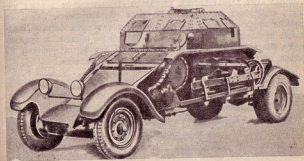
Рис. 316. Польская танкетка ТК-3, погруженная на безмоторное колесное шасси. Видна цепная передача, идущая от ведущего колеса танка.
