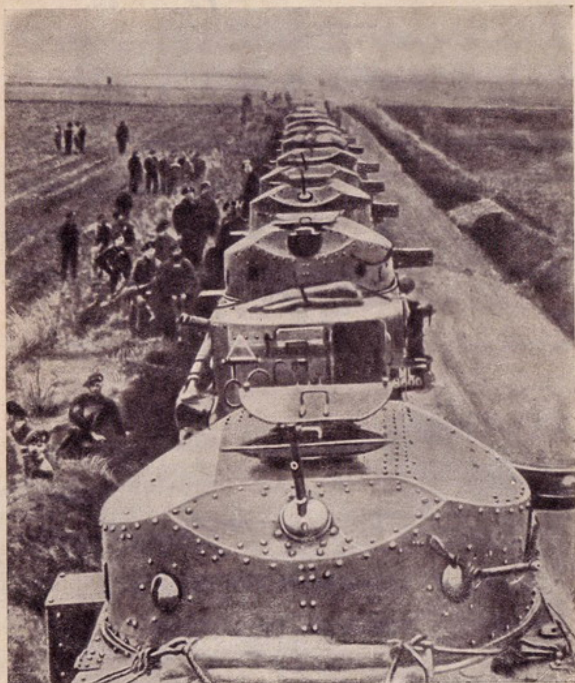
Рис. 150. Скошенная сзади башня среднего танка марки IA. На рисунке виден на скосе зенитный пулемет. На втором (командирском) танке вместо пулемета виден цоколь для мачты антенны, задние башенные пулеметы не установлены для удобства пользования радио и выдвижения телескопической мачты антенны. Средний танк марки IA виден на рис. 153 (правая машина). На нем видна пулеметная бронировка отделения водителя.
