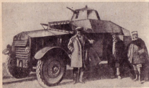
Рис. 223. Бронированный грузовик Рено 1929 г., вид сбоку. Открыт погрузочный люк.
