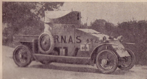
Рис. 68. Легкий броневый автомобиль Ланчестер 1912 г. Данные: вес — 4,75 т; мотор — 60 л. с.; максимальная скорость — 60 км/час; вооружение — 1 пулемет или одна 37-мм пушка; броня — 8 мм; привод — только на заднюю ось; шины — гусеничные.
