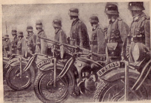
Рис. 392. Пулеметная установка на германском мотоцикле. Допускает стрельбу из пулемета как с машины, так и с земли.
