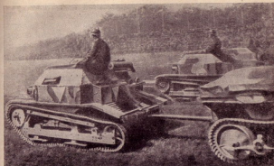
Рис. 339. Польский разведывательный танк ТК-3. Вид сзади с гусеничной прищепкой.
