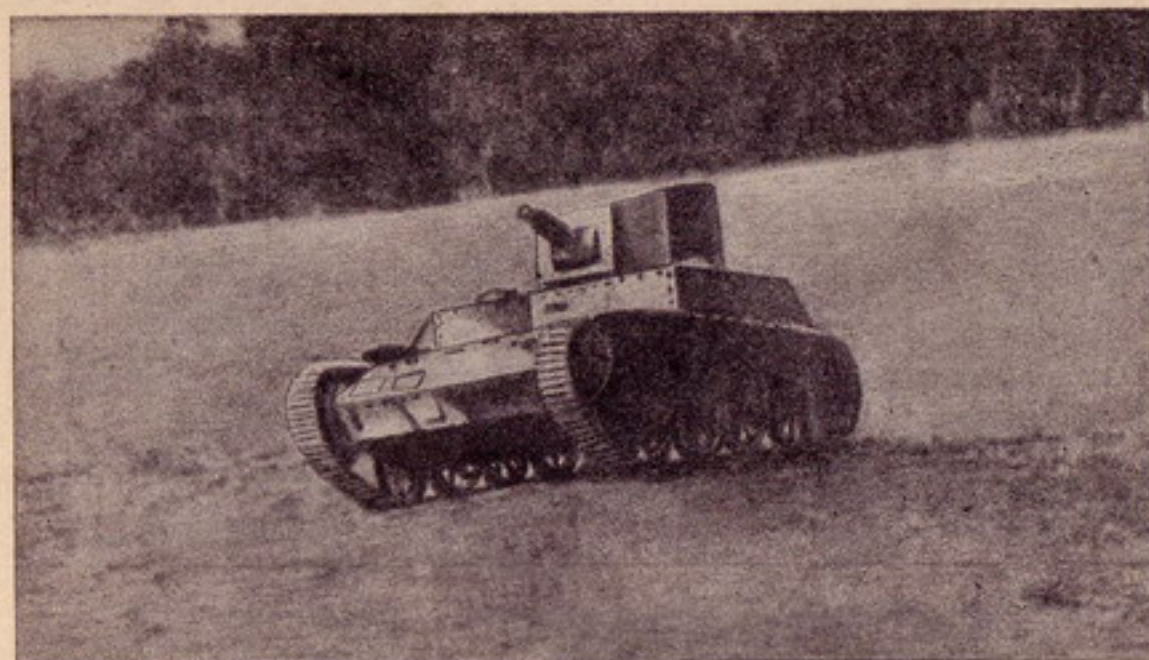
Рис. 131. Легкий танк марки I, вид спереди на ходу. В фирменной типовой серии Карден-Лойд марки VII первые 6 опытных машин получили в армии наименование «легкий танк марки I».
