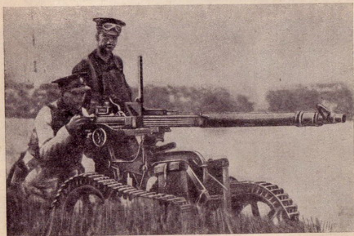
Рис. 118. 22-мм автоматическая пушка Эрликон в положении для стрельбы в придорожной канаве. Виден гусеничный движитель пушки. Неуказанная ось находится посередине движителя.
